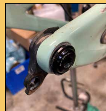
The universal derailleur hanger (UDH) for standard derailleur. Photo by Tom Jow
